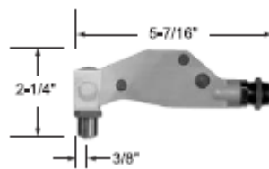
H753A-456 直角拉头 NSN 5130-01-393-2926 军用零件编号 M85188S2
