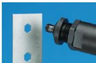
74290 工具冲压出带有六角孔的工件，然后开始安装 Hexsert®螺母
