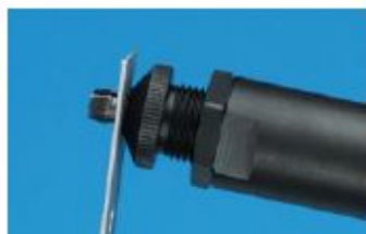
把冲头插入圆孔里（已安装到 74290 工具上）
